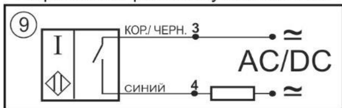
Схема соединения Нормально-разомкнутый контакт
